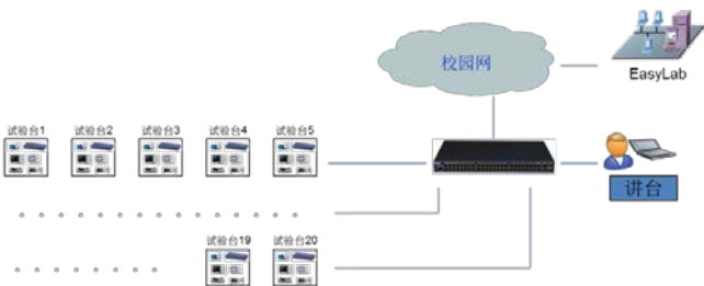
图 11 实验台通过网络接口连入校园网
